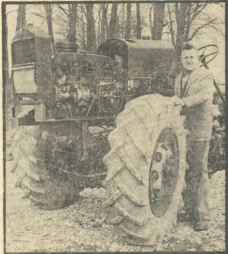
En verklig koloss är lantbr. Sigvard Jönssons senaste experimentmaskin, en 4-hjulsdriven lastapparat.
