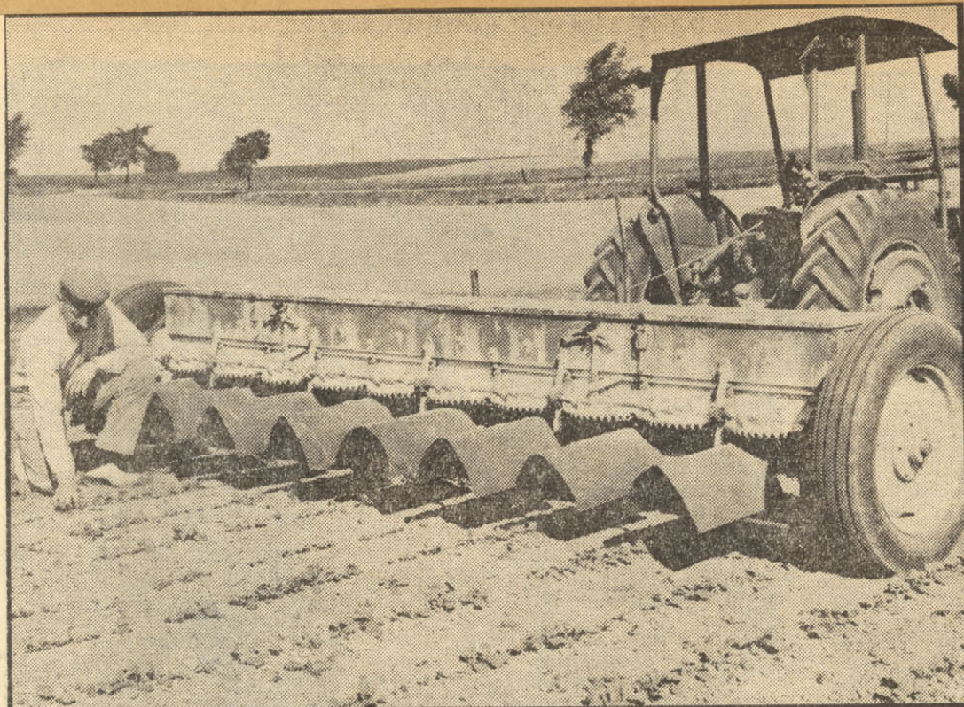
Här ses konstruktionen monterad på handelsgödselspridaren sådan den skall sitta när spridning utföres.
