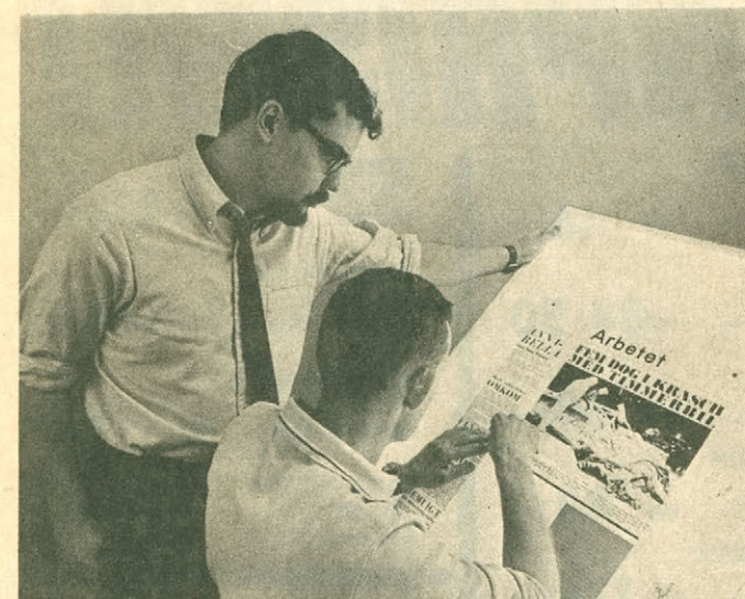
Så får det bli! Lars Johnson har tagit steget över från den konventionella ombrytningen med blymaterial till sidmontering vid ljusbord. Här gör han en sida åt Björn Gustavsson.
