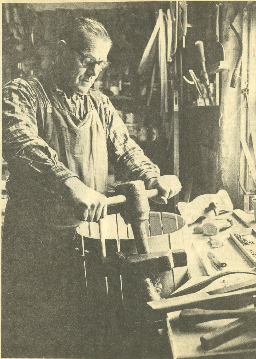
Det är fart över jobbet när tunnbindare Carl Wallin i Rydsgård pressar ihop stavarna med s. k. snurr
