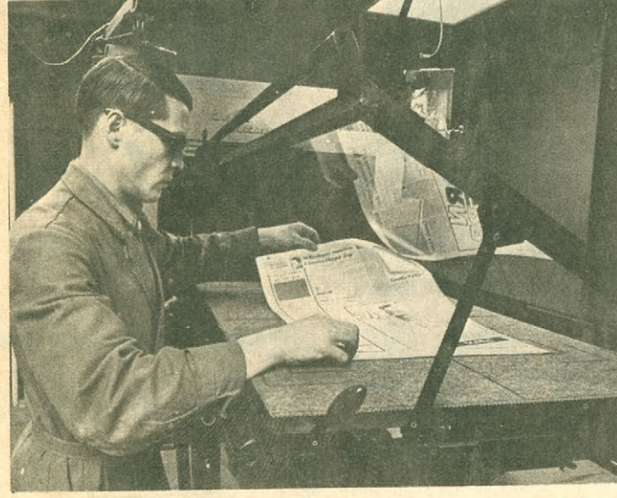
Från monteringen vandrar de klistrade sidorna in till reproavdelningen. Där förvandlar Sven Lindholm och hans kolleger dem till filmnegativ med hjälp av den toppmoderna reprokameran.
