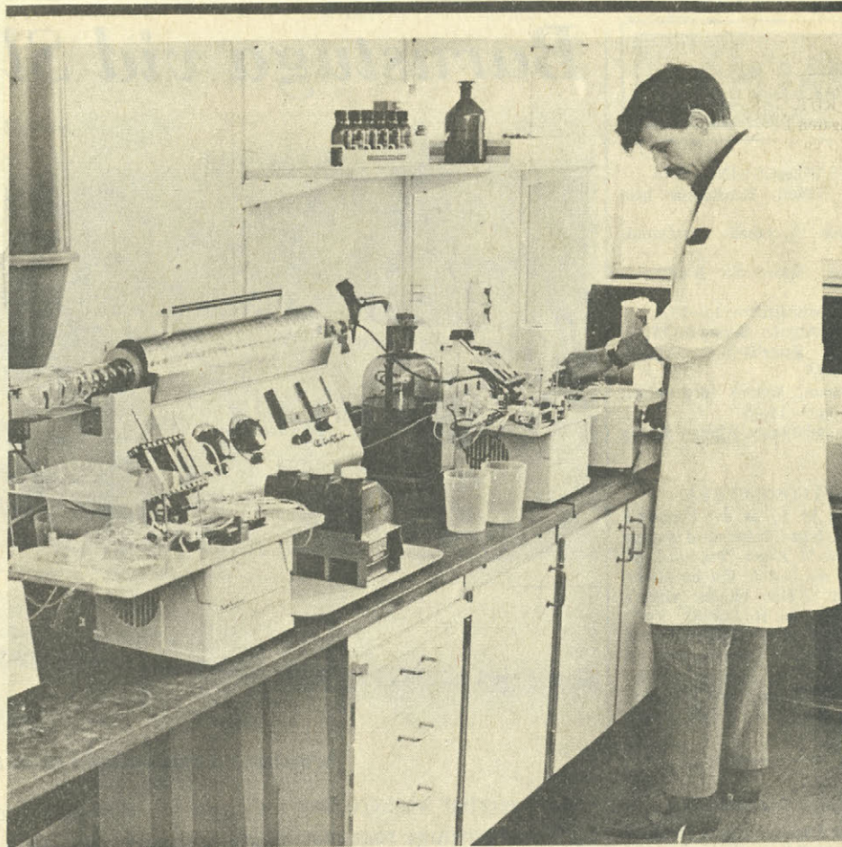
Proteinhalten i varorna bestämmes automatiskt i denna apparat, som arbetar enligt Kjeldahlmetoden. Apparaten är den enda i sitt slag i Europa när det gäller automatisk proteinhaltbestämning i kött och charkvaror. Bilden visar lag.ing. Kurt Kolar i arbete med den detalj där proven upptas.
